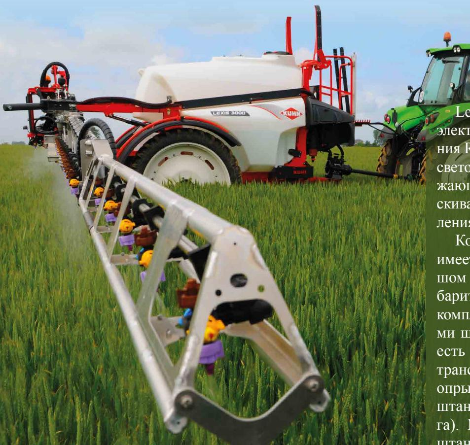
Lexis позволяет установить электронные блоки управления RPB, REB3 или Visioreb со светодиодной панелью, отражающей все параметры опрыскивателя, и функцией управления секциями через GPS.
