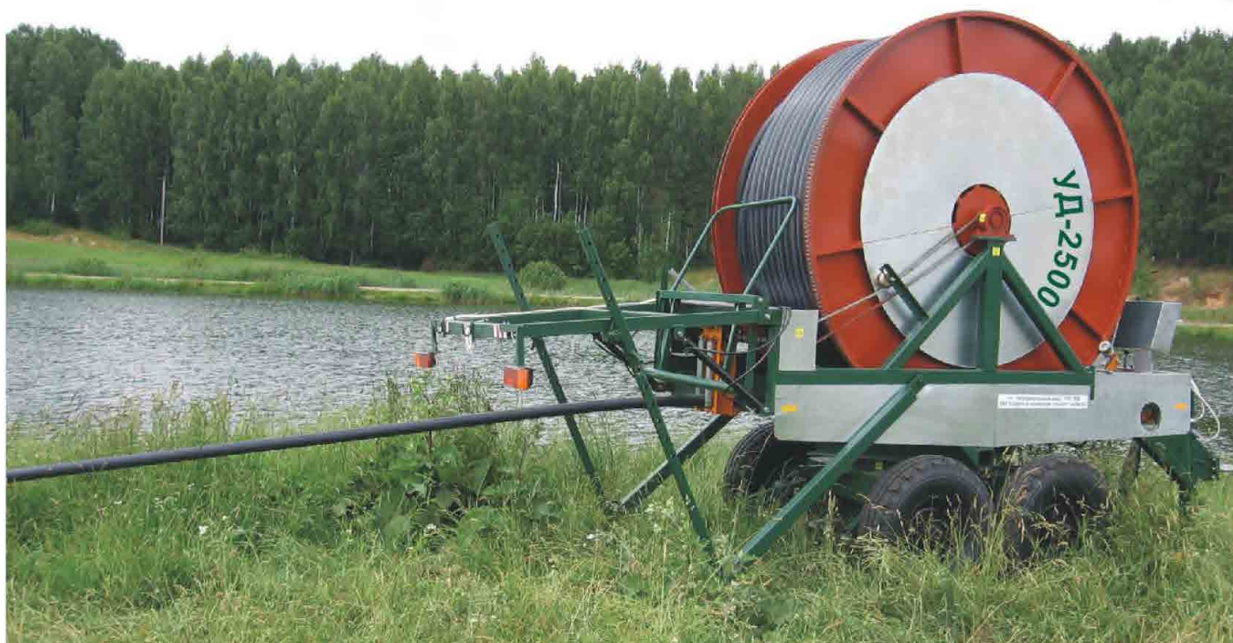
Рисунок 1. – Общий вид мобильной барабанно-шланговой дождевальной установки УД-2500
