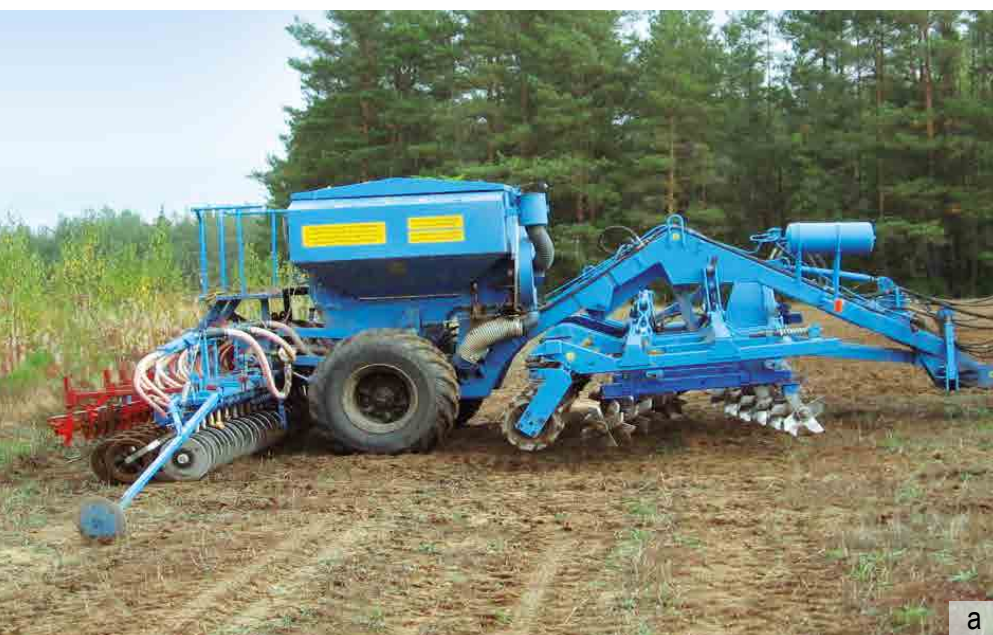
Рисунок 3. – Сеялка пневматическая широкозахватная С-9
