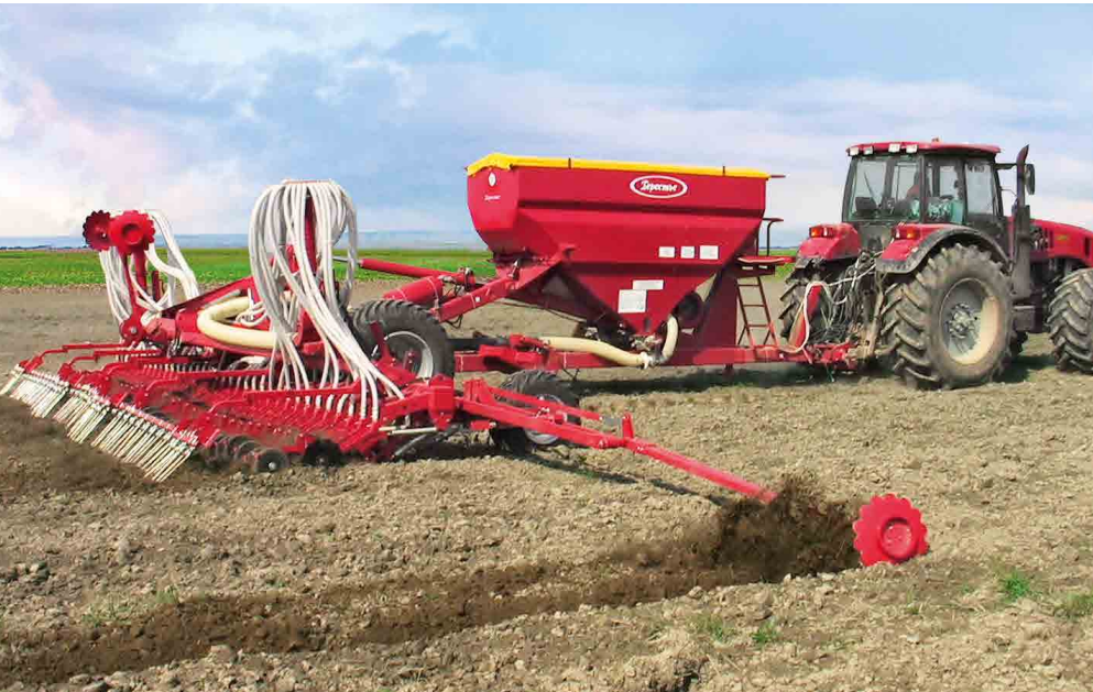
Рисунок 3. – Сеялка пневматическая широкозахватная С-9
