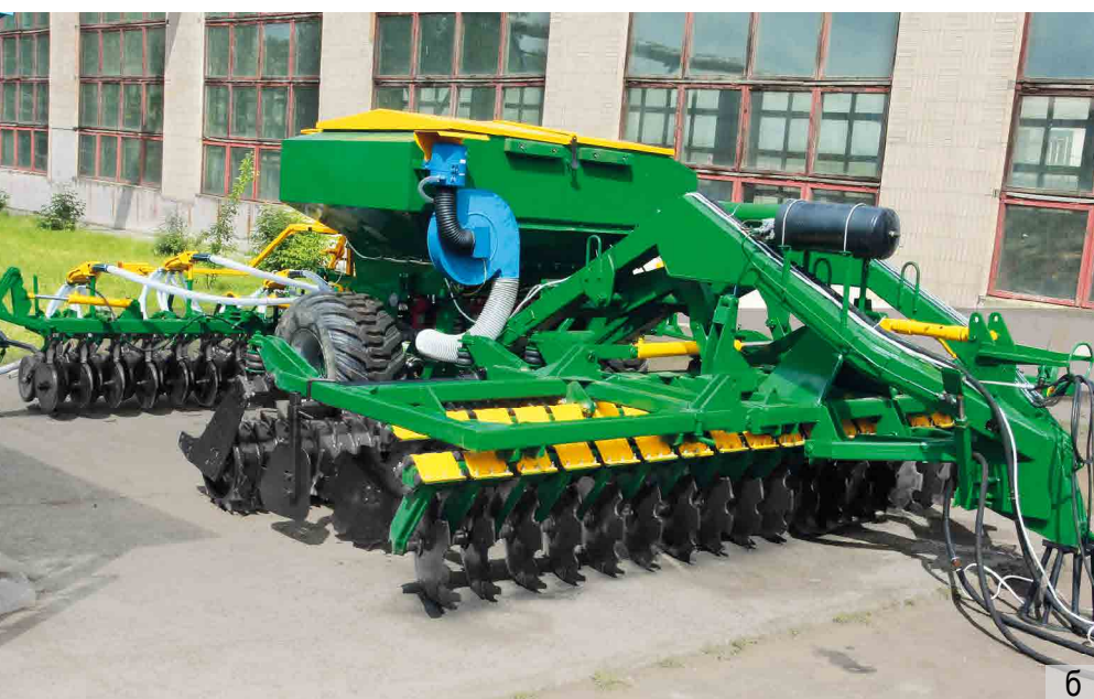
Рисунок 4. – Агрегат почвообрабатывающе-посевной: а) АППА-6-02; б) АППА-6-03
