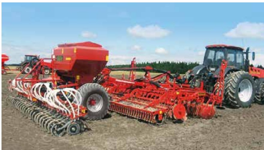
Рисунок 14. – Агрегат почвообрабатывающий посевной АПП-6Д с дисковыми рабочими органами
