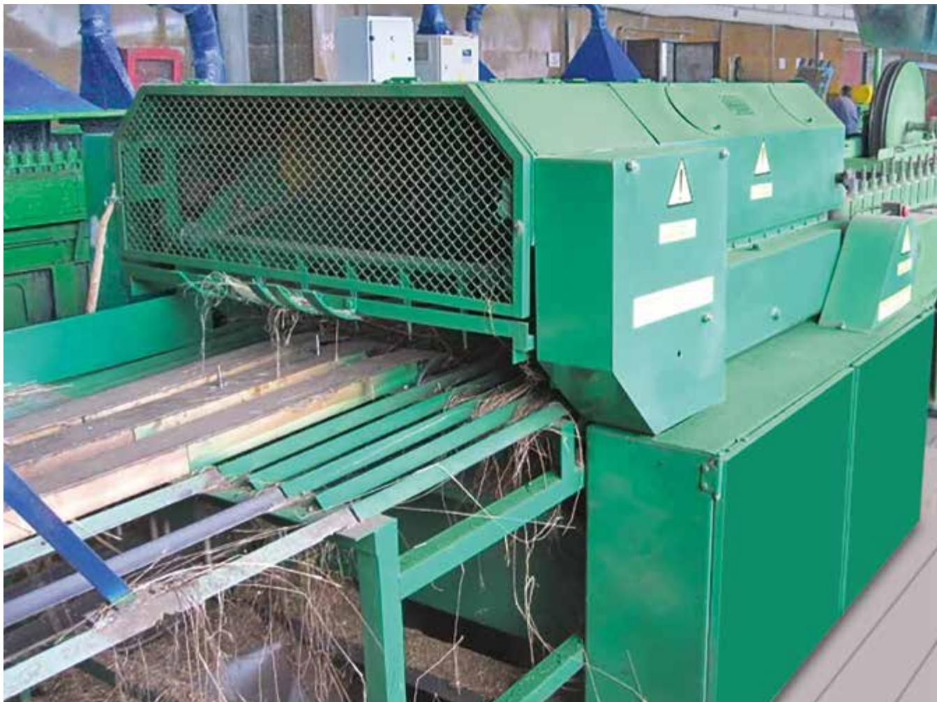
Рисунок 2. – Машина слоеформирующая МС-6,97 в составе мяльно-трепального агрегата МТА-2Л
