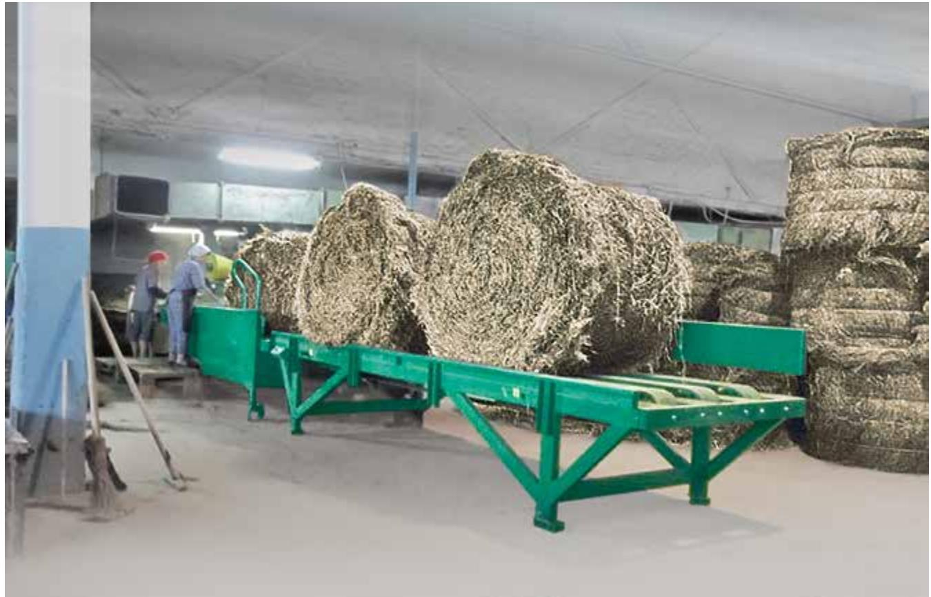
Рисунок 1. – Машина раскладочная МР-1400 на производстве
