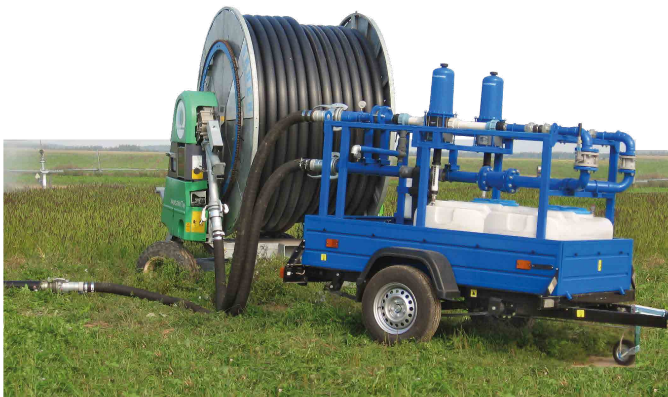
Рисунок 4. – Оборудование для гидроподкормки ОГД-50 на испытаниях в опытном оросительном комплексе «Тушково» УО «БГСХА»
