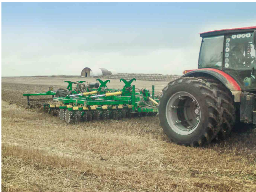
Рисунок 2. – Агрегат почвообрабатывающий многофункциональный на лушении стерни
