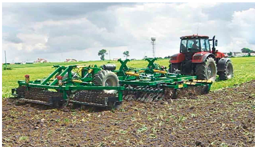
Рисунок 1. – Агрегат почвообрабатывающий многофункциональный на обработке пласта многолетних трав
