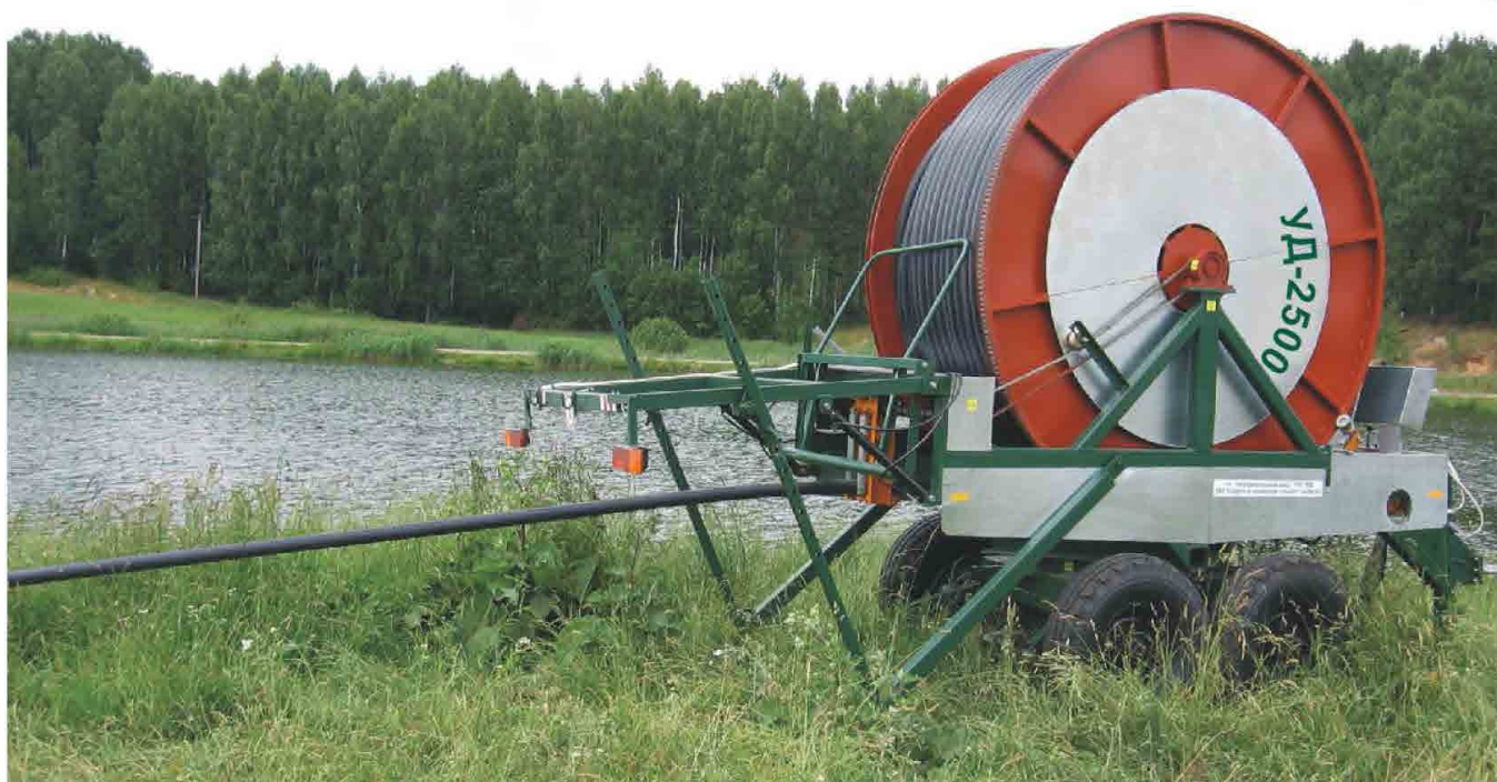
Рисунок 1. – Общий вид мобильной барабанно-шланговой дождевальной установки УД-2500
